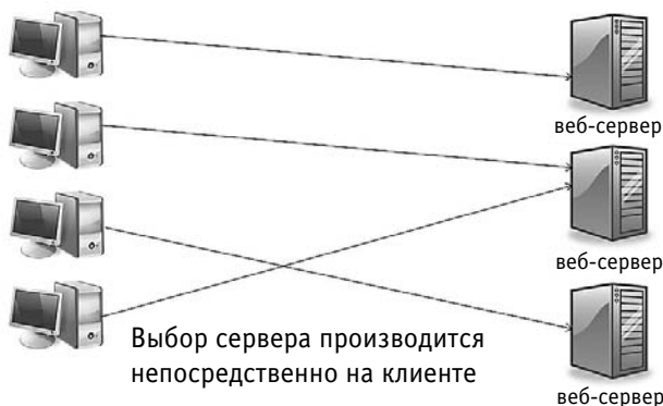
Рис. 5.3. Пример балансировки нагрузки и масштабируемости на клиенте
